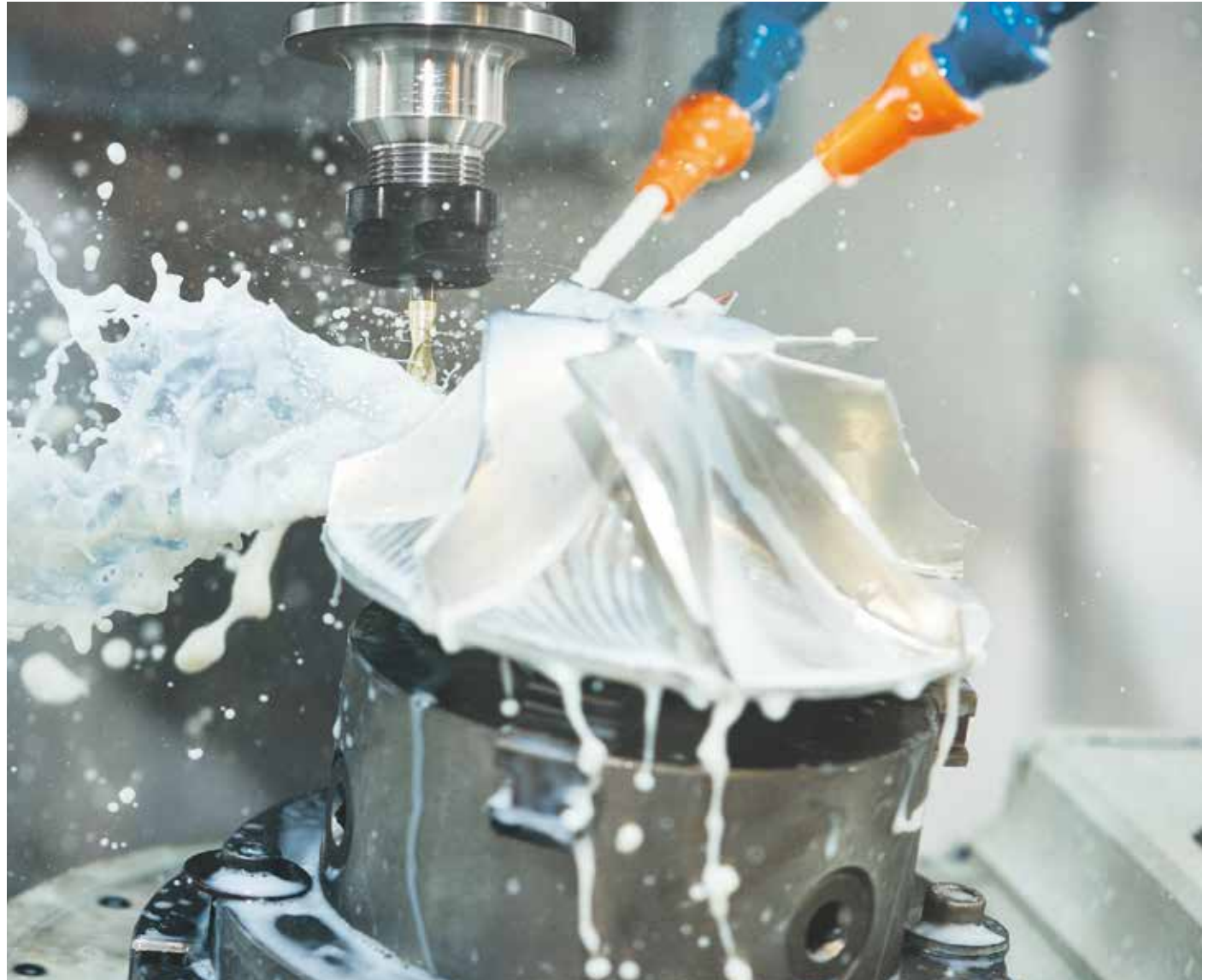
Ecocool Ultra-Motive is een universele metaalbewerkingsemulsie die geschikt is voor alle verspanende bewerkingen bij alle metaalsoorten.
